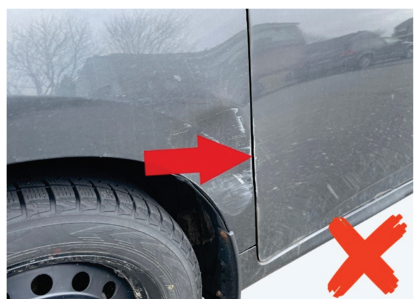
Domage mineur sur un panneau extérieur (porte)
