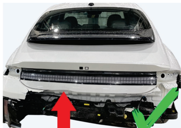
Domage sur une petite partie d'un panneau extérieur avec moulure de séparation (cas exceptionnel)
