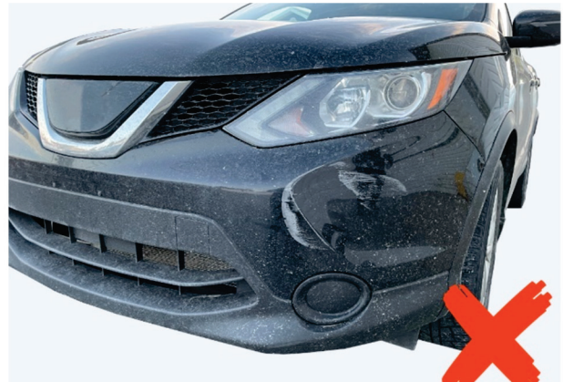
Domage sur le coin avant du couvre-pare-chocs (situé sur la face avant)
