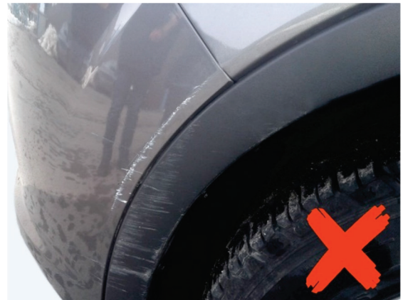
Domage sur le côté du couvre-pare-chocs (aucun autre panneau extérieur à repeindre)
